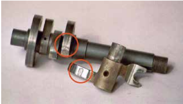
Starker Verschleiß und Pittingbildung an Nockenwelle und Kipphebel einer Ducati
